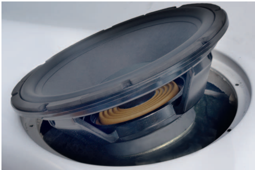
Ein Druckgusskorb, ein sehr starker Ferritmagnet, eine harte, für extreme Hübe optimierte Zentrierung und eine gehärtete Pappmembran: Das 12-Zoll-Chassis kann die Gene aus dem PA-Bereich nicht verleugnen. Die eher weiche Schaumstoffsicke dagegen verrät auch eine HiFi-Affinität.
