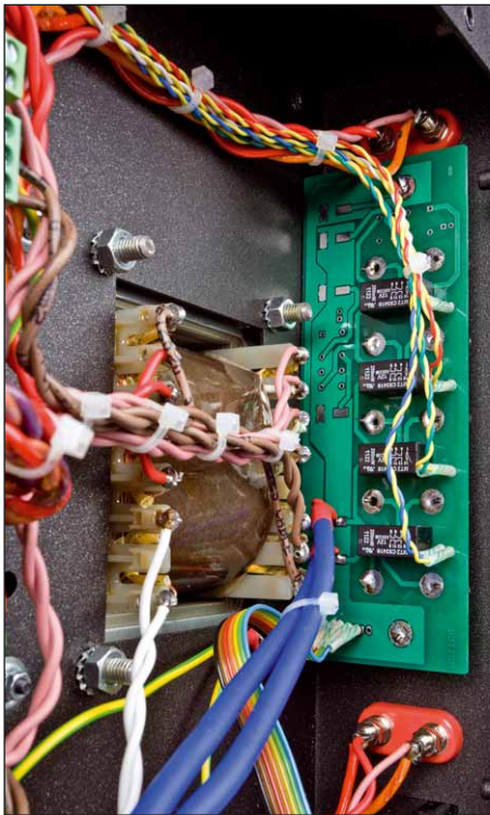
Im Sinne kürzester Signalwege werden die Eingänge direkt an den Buchsen per Relais umgeschaltet
